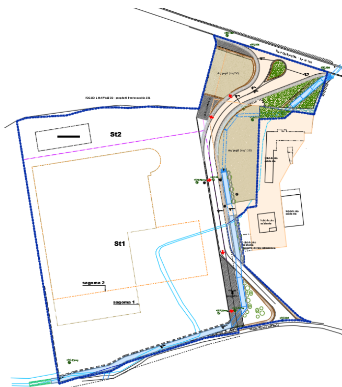
TAV 04_ PROGETTO – Aree a servizi – Viabilità – Canale ricollocato
